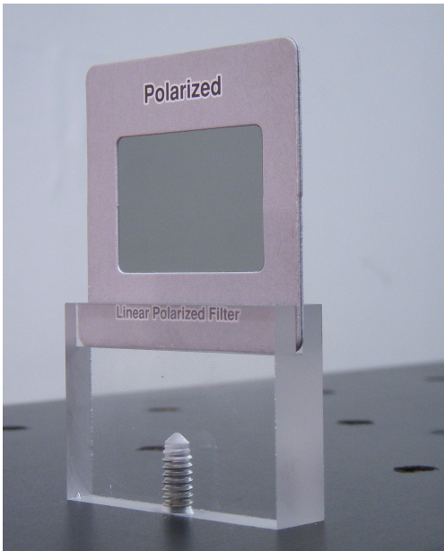
Plėvelinis poliarizatorius skaidrės rėmelyje, įtvirtintas plastikiniame stove (žymė J).
